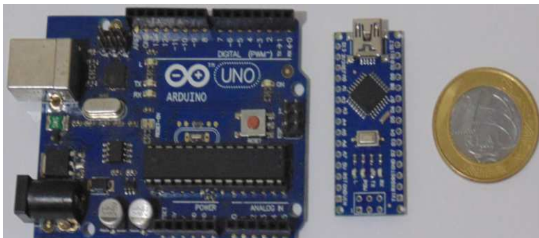
Figura 2.4 – Imagem do Tamanho Comparativo entre Arduinos Uno e Nano e uma moeda de R$ 1,00.
