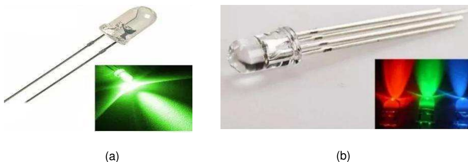
Figura 1.6 - Imagem (a) LED emitindo na cor verde, e (b) um LED RGB.
