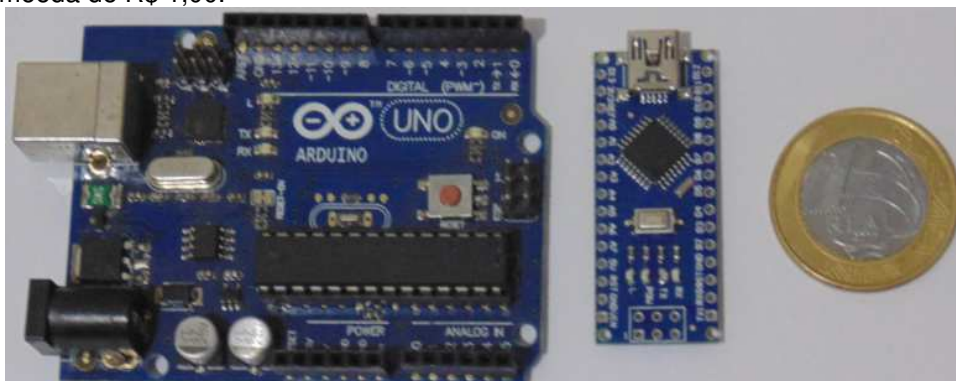
Figura 2.5 - Tamanho Comparativo entre Arduinos Uno e Nano com uma moeda de R$ 1,00.
