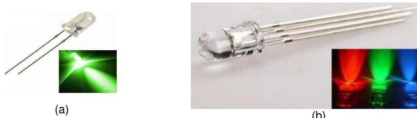
Figura 1.10 - Imagem (a) led emitindo na cor verde, e (b) um led RGB (Red (vermelho), Green (verde), Blue (azul)).
