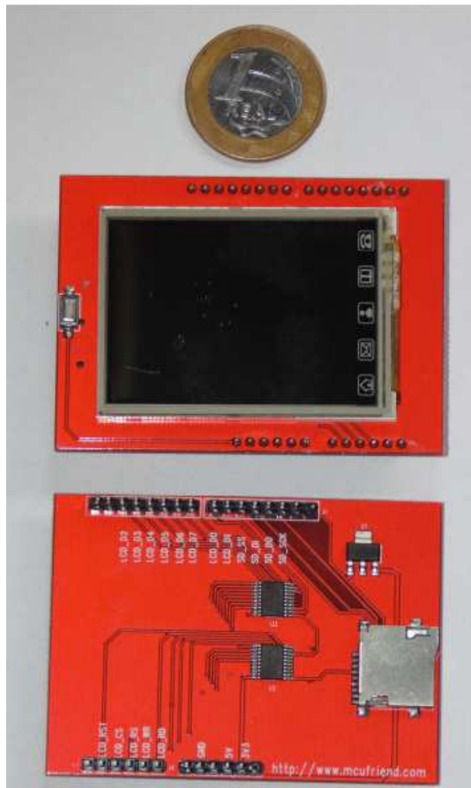
Figura 2.7 – Imagem da placa TFT Display comparada com uma moeda de R$1,00.
